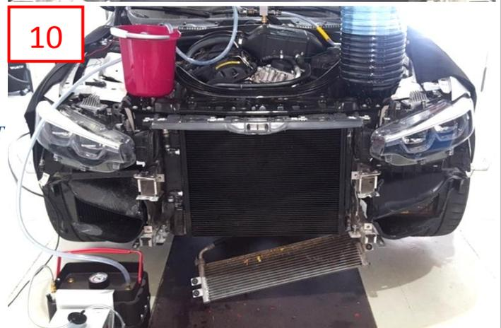
Montieren Sie die WT Carbon Luftführung mit Hilfe der mitgelieferten Montagebleche, M6 Sechskantschrauben und Unterlegscheiben am WT Wasserkühler (11 & 12).
