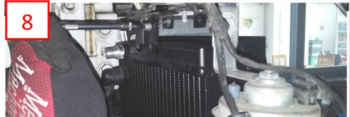
Montieren Sie den WT Front-Wasserkühler an den originalen Befestigungspunkten des Fahrzeugs (9) und verbinden Sie dessen Schlauchanschlüsse. Schrauben Sie die Befestigungsschraube des unteren Kunststoffrahmens wieder fest (6).
