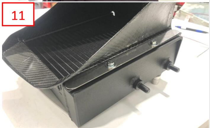
Aufgrund von Fertigungstoleranzen **kann** es vorkommen, dass zwischen WT Carbon Luftführung und WT Wasserkühler ein kleiner Luftspalt bleibt. In diesem Fall versehen Sie die WT Carbon Luftführung noch vor dessen Montage mit den mitgelieferten Kantenschutzbandern, damit diese luftdicht zum WT Wasserkühler abschließen kann (13).
